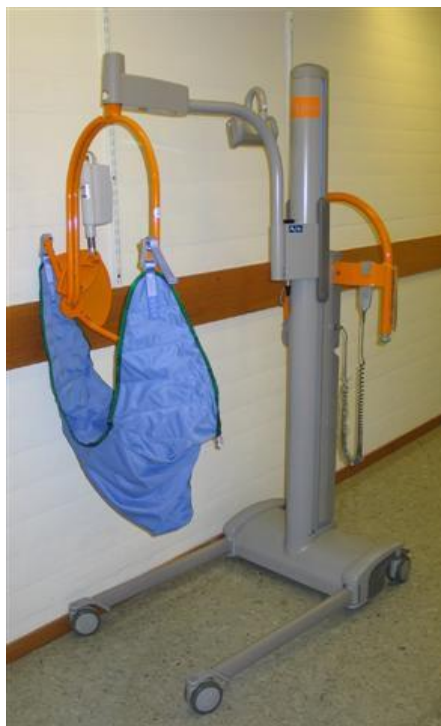
F1_7. ábra. Áthelyezést segítő eszköz, elektromechanikus emelő (Európai Munkahelyi Biztonsági és Egészségvédelmi Ügynökség; eredeti ábra)
